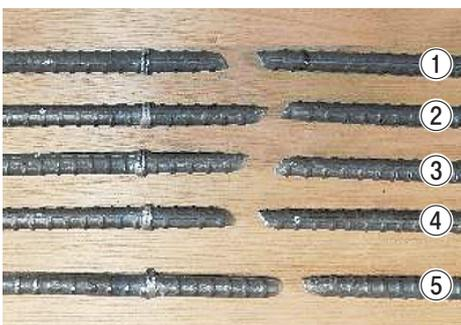
■ コブ径を1.1dに削った溶接性確認引張試験結果
